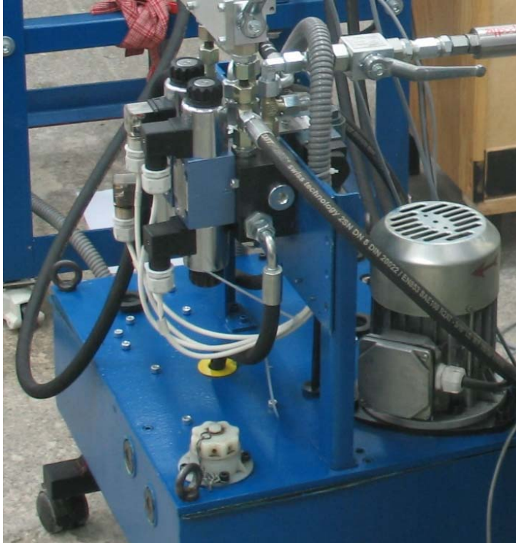
Rys. 8. Zasilacz hydrauliczny ZH6B użyty na stanowisku ćwiczeniowym
