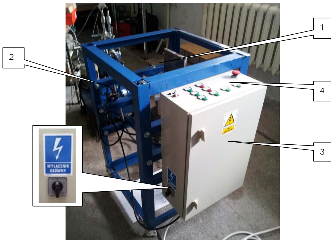
Rys. 5. Widok stanowiska diagnostycznego z podajnikiem Fext: 1-podajnik zaciskowy, 2-zasilacz hydrauliczny, 3-szafa sterownicza, 4-pulpit operatora
